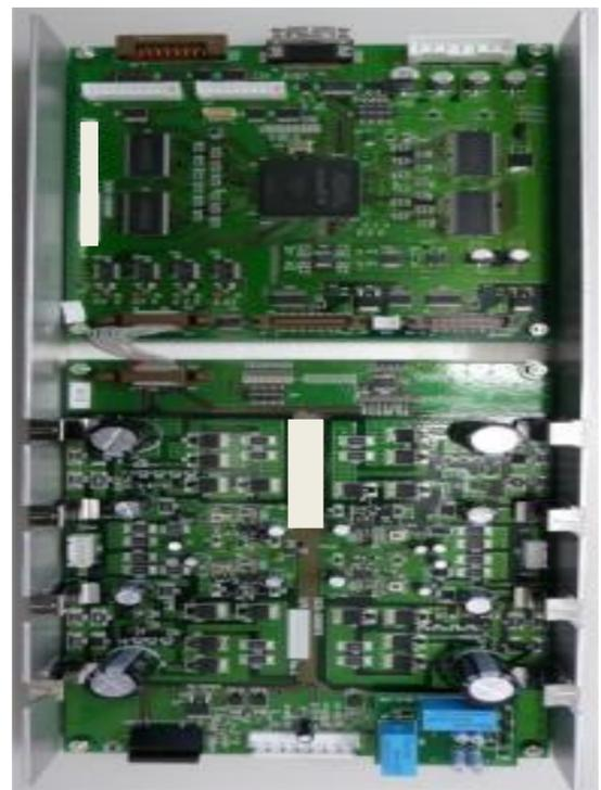
Dimatix用ヘッド駆動制御基板。PQ/QS/QEをフルスペックで制御可能です。パルス幅可変可能です。ヘッド駆動波形生成ソフト(オプション)があります。吐出周期最大20kHz。搬送系エンコーダと同期可能。印刷用PCと専用PCIe基板で接続可能です。最大10ヘッド可能です。印刷にはBitMAPデータが使用可能です。印刷制御ソフトもあります。
