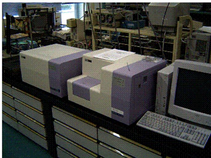
図 III. 2-1-1-④-4. 光電子分光装置（AC2）
