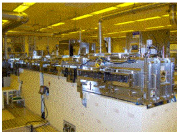
図 III.2-2-1-②-2. 膜封止装置（VITEX 社製）
