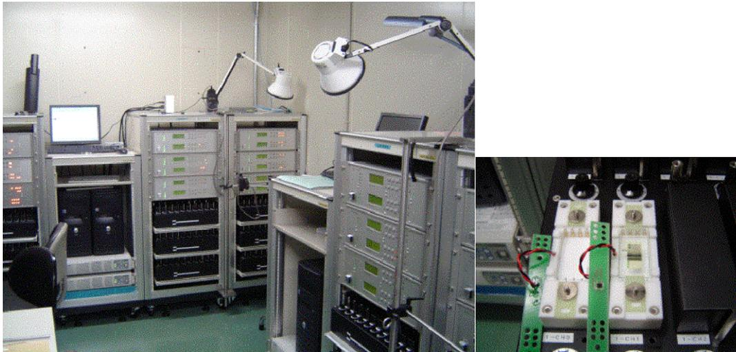
図 III.2-1-2-⑤-6. 寿命特性評価装置（左：外観、右：素子取り付け部）
