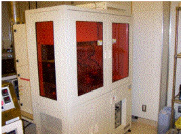
図 III. 2-1-2-①-5. 露光機
