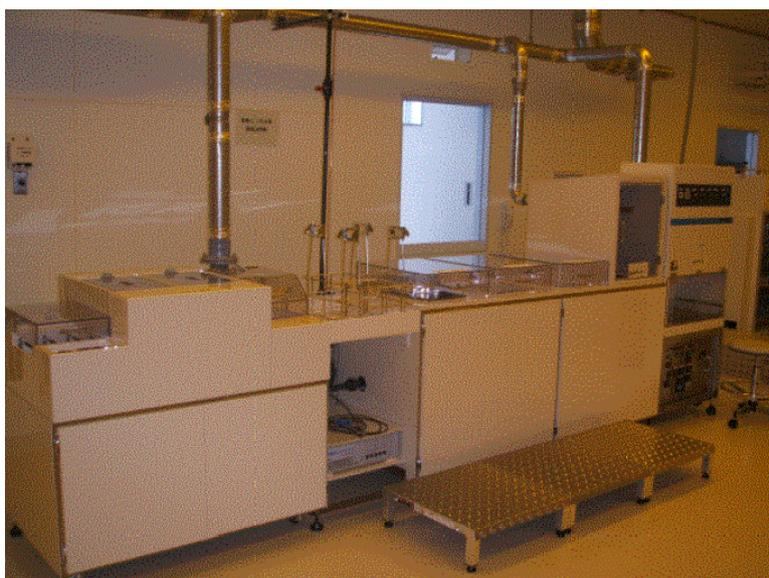
図 III.2-1-2-①-2. 基板洗浄装置
