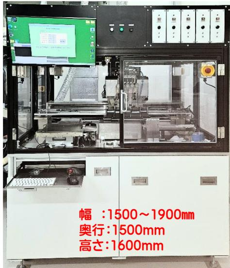
※貧溶媒塗布による結晶化装置製作可能
