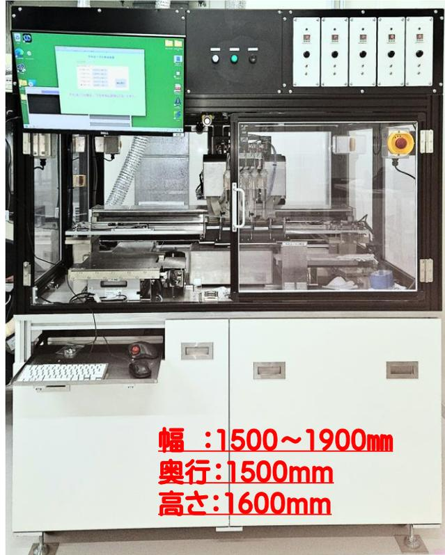
※. 貧溶媒塗布・結晶化装置製作可能
