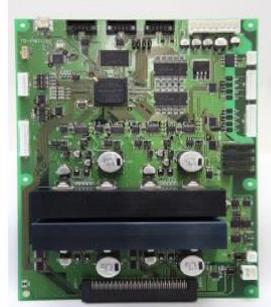
・GEN5用ヘッド制御部と駆動AMPが一枚基板になっています。
