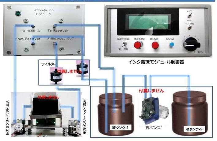
i. ヘッド内部のインク圧力の安定化制御 ii. ヘッド内部の洗浄液循環・排出 iii. インク交換時の内部残留空気の排出制 iv. 総循環量:循環系路配管に依存
