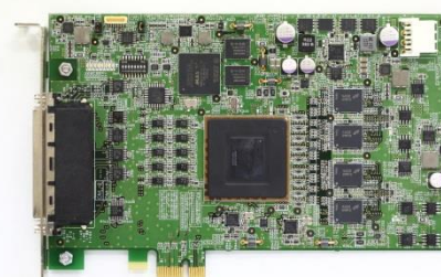
高速・大量データ制御用 PCIe基板(10枚基板対応)
